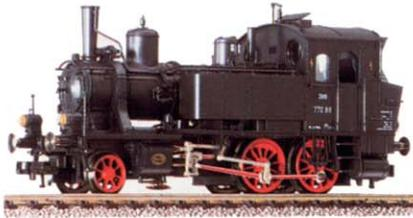
Tenderlok der ÖBB, Baureihe 770, LüP: 107 mm. Motor mit Schwungmasse. Mit Steckschnittstelle nach NEM 651 zum Einbau eines Decoders (DCC: 6876). Kupplungsaufnahme NEM 362. Epoche III.
