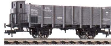
Offener Güterwagen mit Bremserhaus, Bauart Ke der Ö.St.B., LüP: 113 mm. Mit Speichenrädern. Epoche II.
