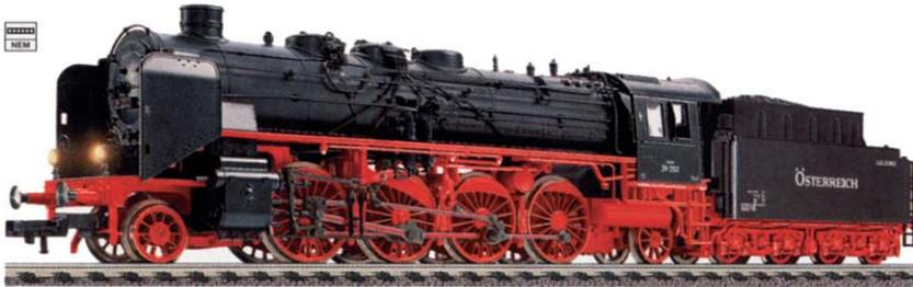
Schlepptenderlok 39 202 mit Einheitstender 2'2' T 34, LüP: 265 mm. Vorbildgetreuer Durchblick zwischen Kessel und Fahrwerk. 5-poliger, wartungsfreier Motor. Steckschnittstelle nach NEM 651 zum Einbau eines Decoders (DCC: 6876). Lok-Tender-Kurzkupplung. Kupplungsaufnahme NEM 362. Kulissenmechanik am Tenderende für echten Kurzkupplungsbetrieb. Epoche III.
