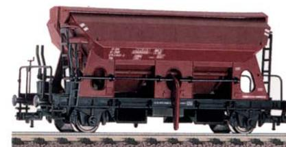
Selbstentladewagen, Bauart Tds der ÖBB, LüP: HO: 122 mm, N: 58 mm. Mit 4 beweglichen Schieberschlüssen am Wagenboden zur automatischen Schüttgutentladung auf der entsprechenden Entladebühne. Epoche V.
