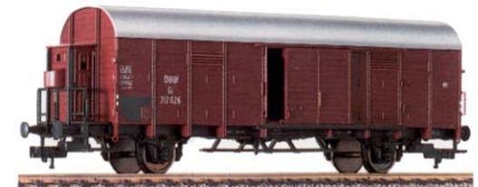
Gedeckter Güterwagen mit Bremserhaus, Bauart Gf der ÖBB, LüP: 147 mm. 2 bewegliche Schiebetüren. Epoche III.
