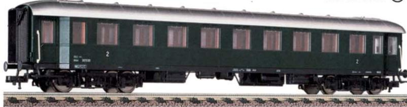
Schnellzugwagen 2. Klasse, Bauart B4üh der ÖBB, LüP: 244 mm. Der Wagen ist für Innenbeleuchtung vorgesehen. Epoche III.
