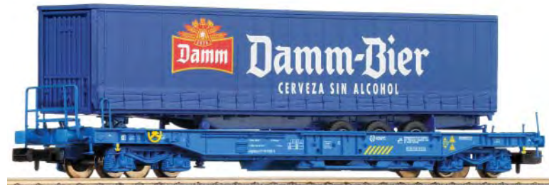
Einheitstaschenwagen der Renfe, beladen mit einem dreiachsigen Sattelaufleger „Damm-Bier“.
