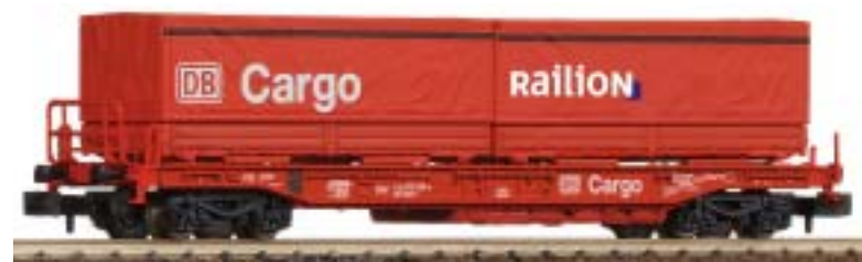
Einheitstaschenwagen, beladen mit zwei Wechsellpitschen. Standard well-flat wagon, loaded with two interchangeable flatbeds. Wagon poche unifié, chargé de deux caisses mobiles bâchées.
