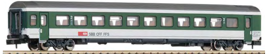
Reisezugwagen 2.-Kl. der Bauart EW IV der SBB.
