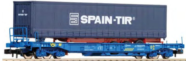
Einheitstaschenwagen der Renfe, beladen mit einem Sattelaufleger „Spain Tir“.
